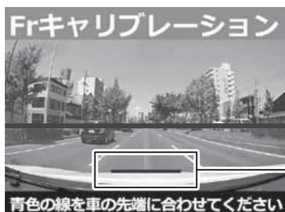
青い線が車両の先端に合うように【アップ】【ダウン】で調整する。
