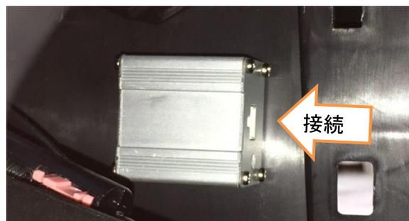
5,ECUを取付け(両面テープ)、電源配線と接続する。
