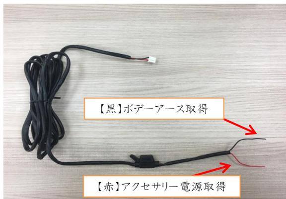
3,車両のアクセサリ電源信号を、電源配線【赤】とエレクトロタップを使用し、取得する。
