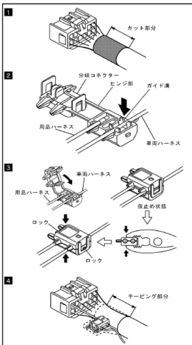
**1** 接続する車両ハーネスがビニールチューブおよびビニールテープで覆われている場合は、適量をカットしてください。
