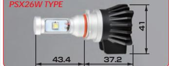
バルブ後方スペースが35mm (HB4タイプの場合は33mm) 以上かつ直径50mmほどのスペースがあれば取付可能 (フォグランプからバルブを外す際に必要なスペースは除く)。※車種によっては、取付時にリバーを外す・フォグランプ灯体を外すなどの作業が必要になる場合がございます。購入前に必ず、使用車両での取付方法をご確認ください。
