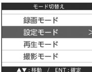
3 **Aボタン**または**Cボタン**を押して変更する設定項目を選び、**Bボタン**を押して確定する。
