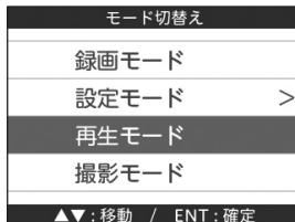
2 **Aボタン**または**Cボタン**を押して【再生モード】に移動し、**Bボタン**を押して確定する。
