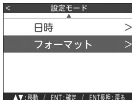
2 AボタンまたはCボタンを押して【設定モード】に移動し、Bボタンを押して確定する。
