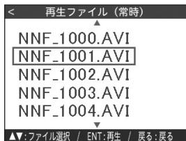
4 **Aボタン**または**Cボタン**を押して再生したいファイルを選択し、**Bボタン**を押して確定する。
