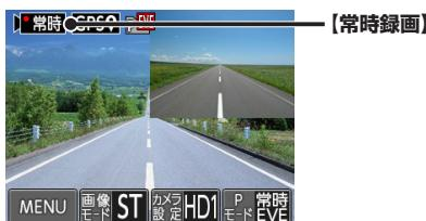
効果音（♪ピロリロリン\*速い）とボイスアシスト（クイック録画を開始します）を出し、クイック録画が開始されます。クイック録画中、動作LEDが速い緑色点滅（0.5秒点灯と0.5秒消灯を繰り返す）します。クイック録画終了後、常時録画モードに戻ります。
