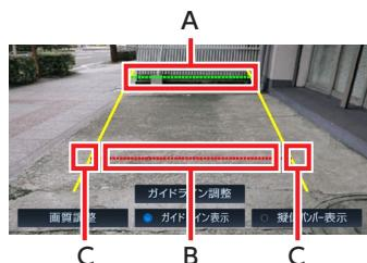
A: 車両後端から約2mの位置を示します。
