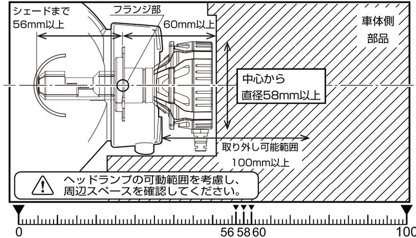
バルブの取り外し可動範囲が100mm以上あればヘッドランプを外さずにそのまま取り付け可能です。
