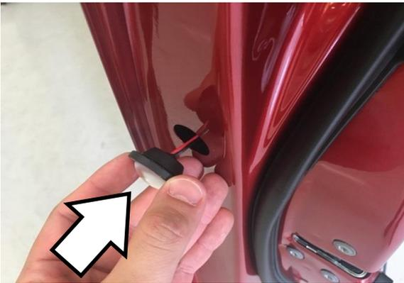
5,LED本体をフロントドア後端のサービスホールに取り付け。
