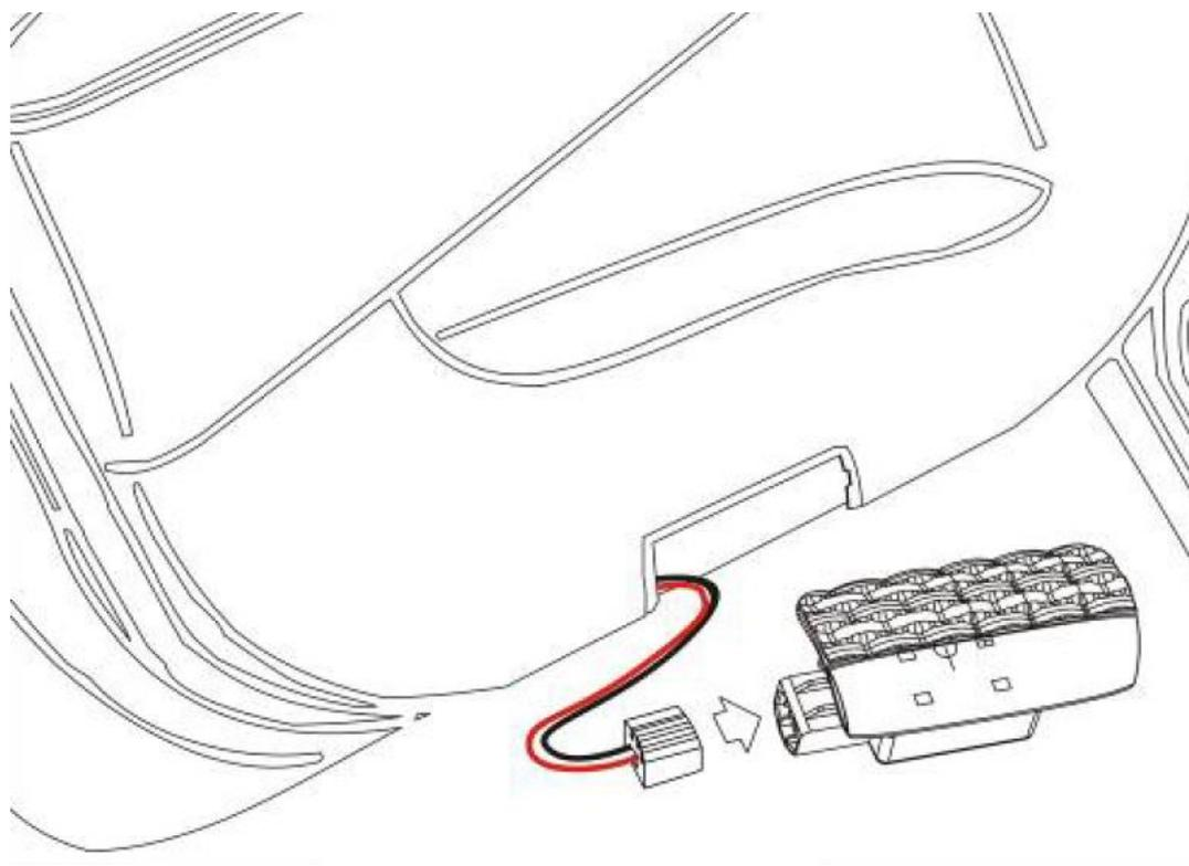
4、ランプ本体を左側から挿入し、右側を押し込むように取り付けます。
