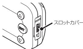
1 本体のスロットカバーをめくり、microSDカードを軽く押し込む。
