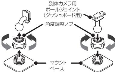
\* 先に別体カメラ用ボールジョイントを角度調整ノブに差し込み、マウントベースに取り付けてください。
