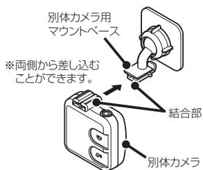
**2 両面テープ（ガラス用）を使用して別体カメラを設置する場所に取り付ける。**
