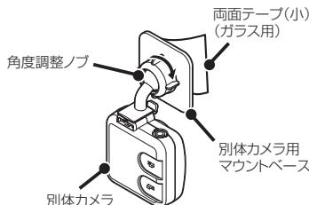
\* 必要に応じて、先に別体カメラ用マウントベースを車両側に取り付けてから別体カメラを設置してください。
