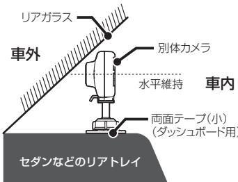
\* 別体カメラの上下切り替えスイッチを↓、正像鏡像切り替えスイッチをM（鏡像）に変更してください。（P25参照）
