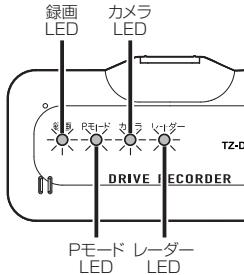
microSDカードが挿入されていない、もしくはカメラの初期化工エラーなどが発生した場合は、次のようなLEDの状態とボイスアシストでお知らせします。
