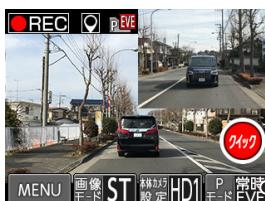
常時電源コードが接続されると、画面に「パーキングモード設定」のアイコンを表示します。
