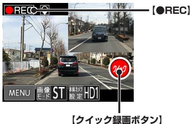
効果音（♪ピロリロリン＊速い）とボイスアシスト（クイック録画を開始します）を出力し、クイック録画が開始されます。クイック録画中、動作LEDが速い緑色点滅（0.5秒点灯と0.5秒消灯を繰り返す）します。クイック録画終了後、常時録画モードに戻ります。
