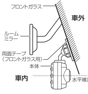
\* フロントガラスの角度によっては、マウントベースのボールジョイントを交換して設置できます。
