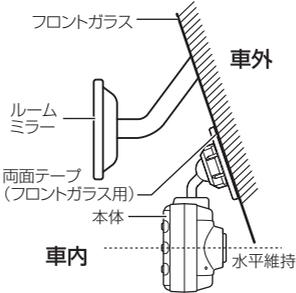
\* フロントガラスの角度によっては、マウントベースのボールジョイントを交換して設置できます。
