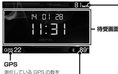
測定している GPS の数を表示します。未測位の場合は、「00」と表示します。
