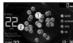
① 現在、測定している GPS 衛星の種類や位置を表示します。
