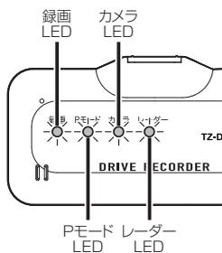
microSDカードが挿入されていない、もしくはカメラの初期化エラーなどが発生した場合は、次のようなLEDの状態とボイスアシストでお知らせします。
